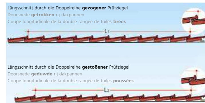
Orientierungs-Decklängen (cm) nach Anzahl der Flächenziegelreihen Latafstand (cm) met he aantal rijen pannen (ter orientatie) Longueurs de couverture d'orientation (cm) en fonction du nombre de rangées de tuiles
